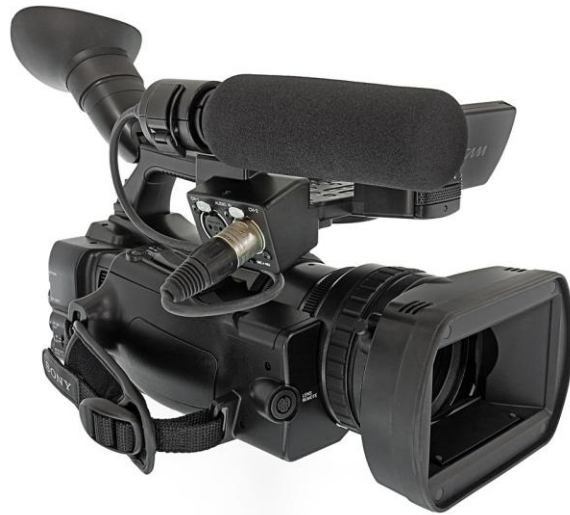
Figure 57 La connexion d'un micro sur une caméra professionnelle
