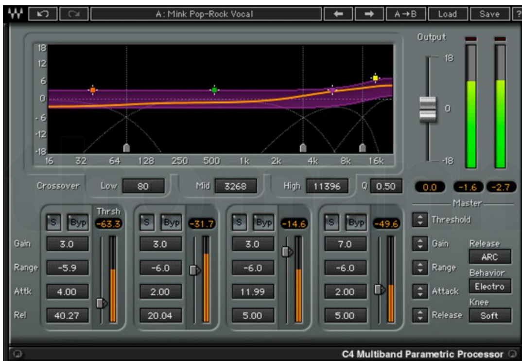
Figure 105 Le compresseur à 4 bandes C4 de Waves avec les réglages de chaque bande
