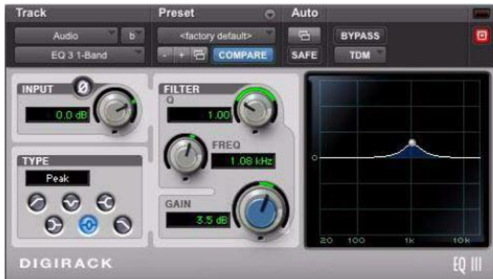
Figure 95 Un filtre passe-bande. Ici, le type de filtre est positionné sur « Peak », le facteur Q est de 1.00, la fréquence est réglée sur 1.08 kHz, et l'action du filtre est de +3.5 dB
