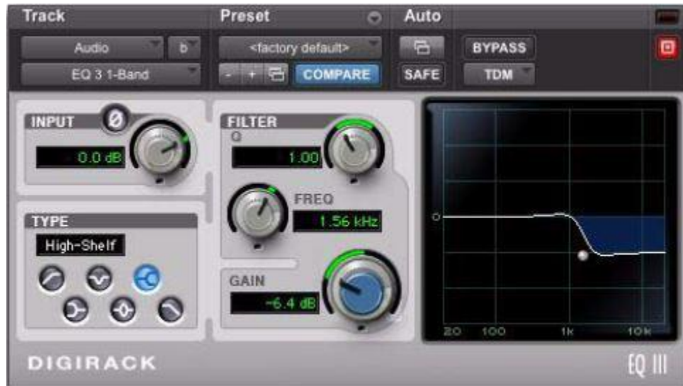
Figure 97 Un filtre en plateau (Shelf). Ici, le type de filtre est positionné sur « High-Shelf », le facteur Q est de 1.00, la fréquence est réglée sur 1.56 kHz et l'atténuation des fréquences supérieures est de -6.4 dB.
