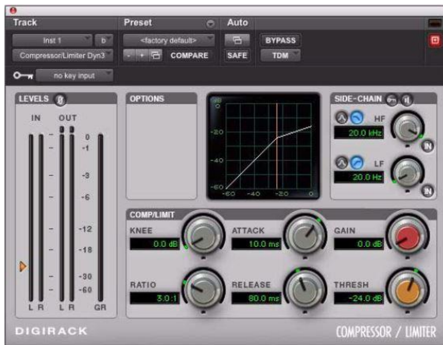
Figure 103 Le compresseur/limiteur de la série Digirack de Pro Tools, ici en version stéréo
