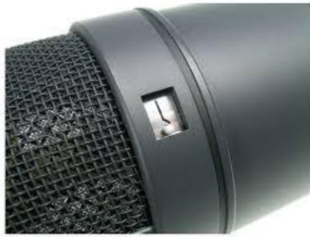
Figure 80 Le switch coupe-bas enclenché sur le micro
