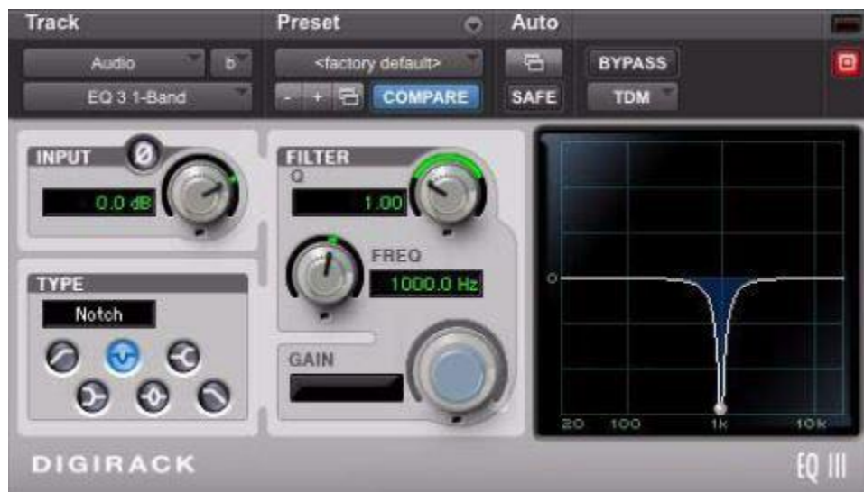
Figure 96 Un filtre éliminateur (Notch). Ici, le type de filtre est positionné sur « Notch », le facteur Q est de 1.00, et la fréquence est réglée sur 1000.0 Hz.
