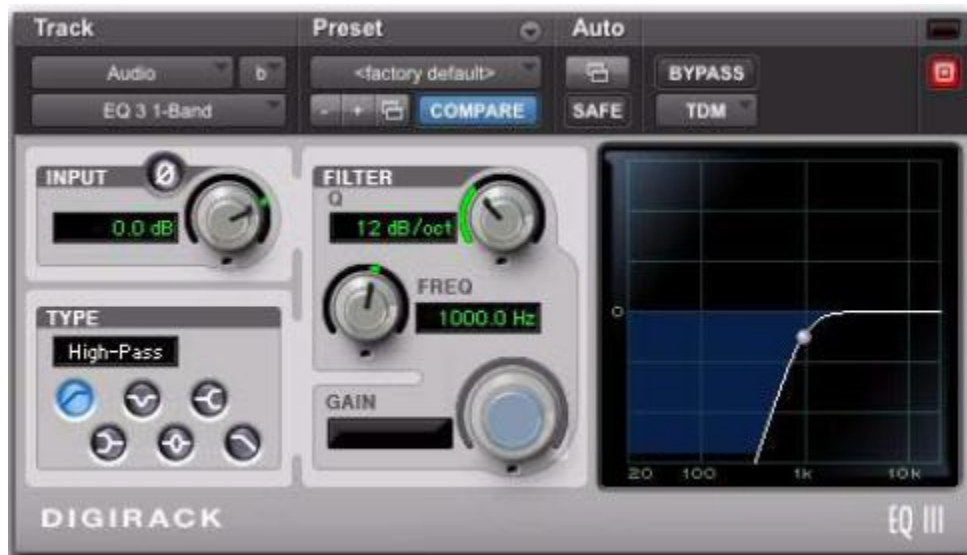
Figure 94 Un filtre passe-haut. Ici, le type de filtre est positionné sur « High-Pass », la pente est de 12 dB/octave, et la fréquence est réglée sur 1 000 Hz
