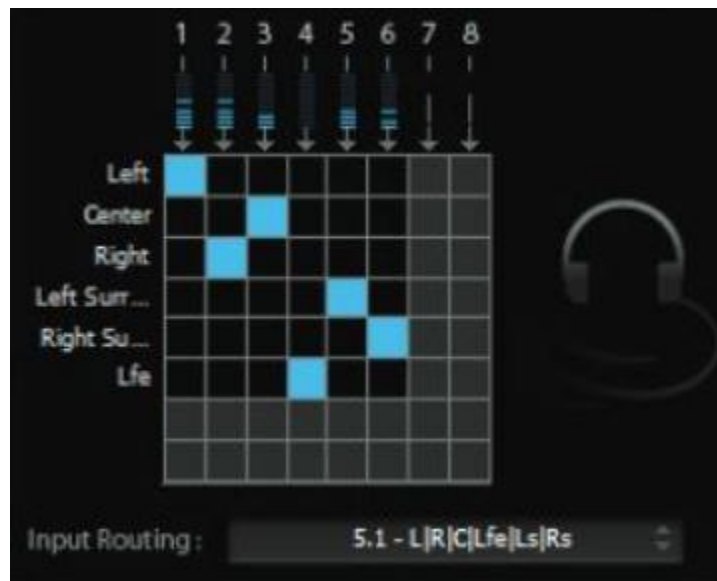
Figure 28 La matrice de répartition du plug-in HEar de l'Ircam.
