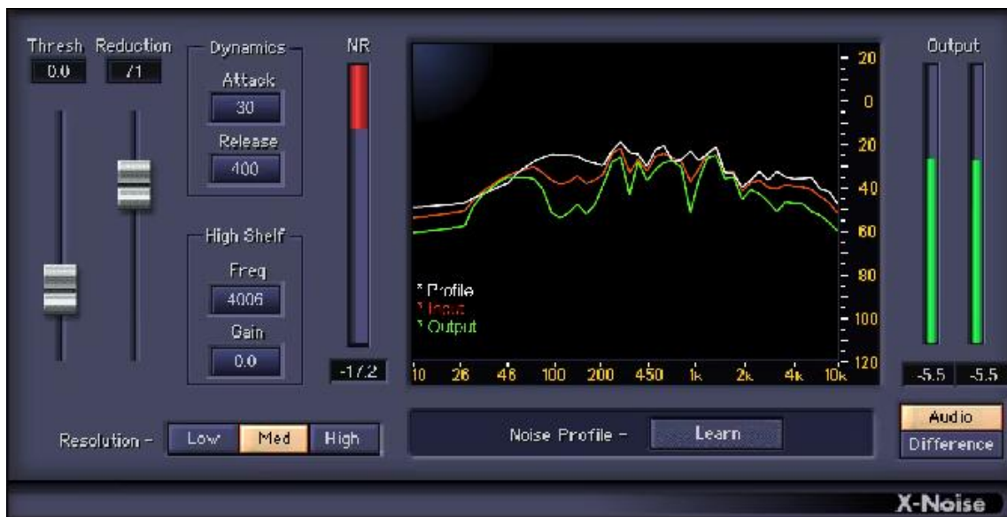
Figure 110 Le plug-in X-Noise de Waves en action. En blanc, la courbe du profil du bruit, en rouge le signal d'entrée et en vert le résultat en sortie. La ligne verticale à gauche de la fenêtre principale montre la réduction du bruit.
