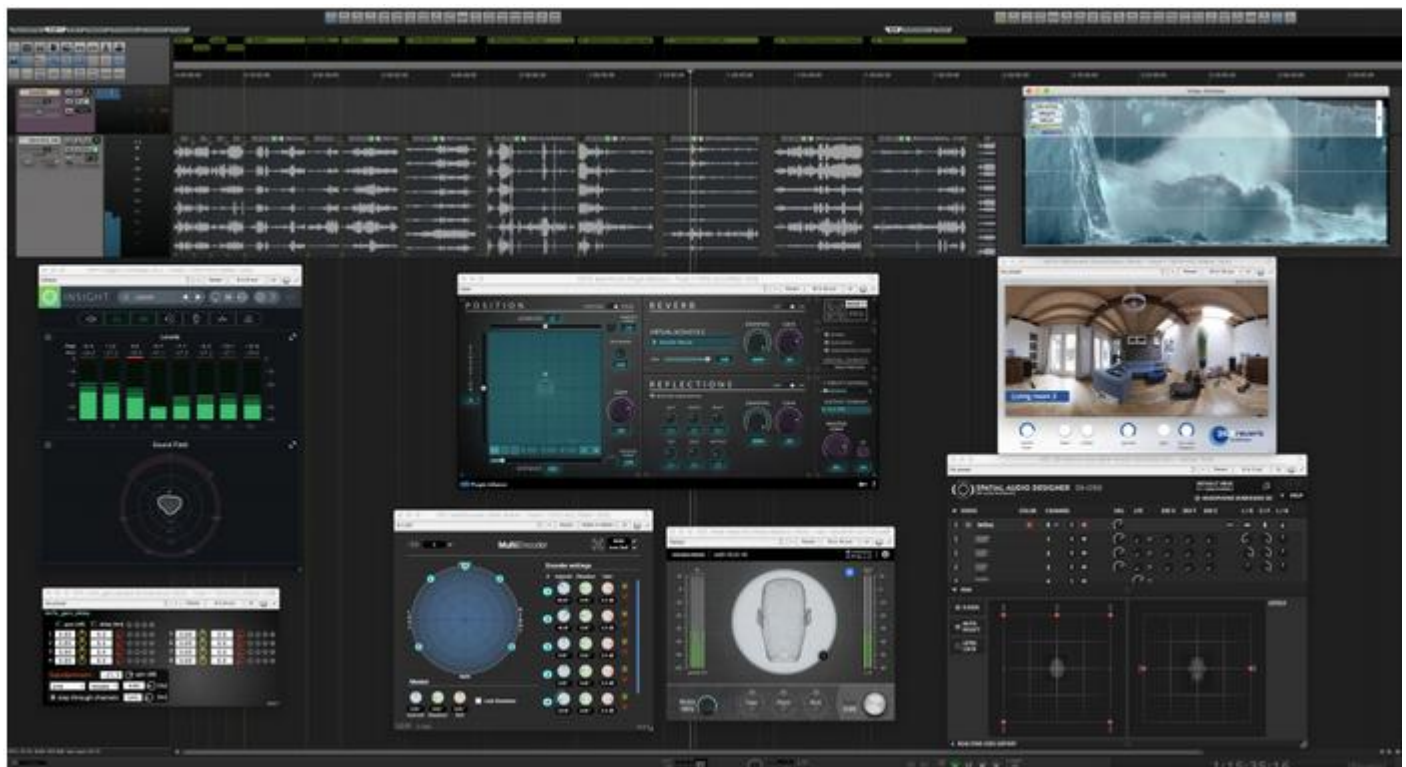
Figure 26 La gestion de l'ambisonie dans Reaper de Cockos (Format-B) avec l'Ambisonic Toolkit
