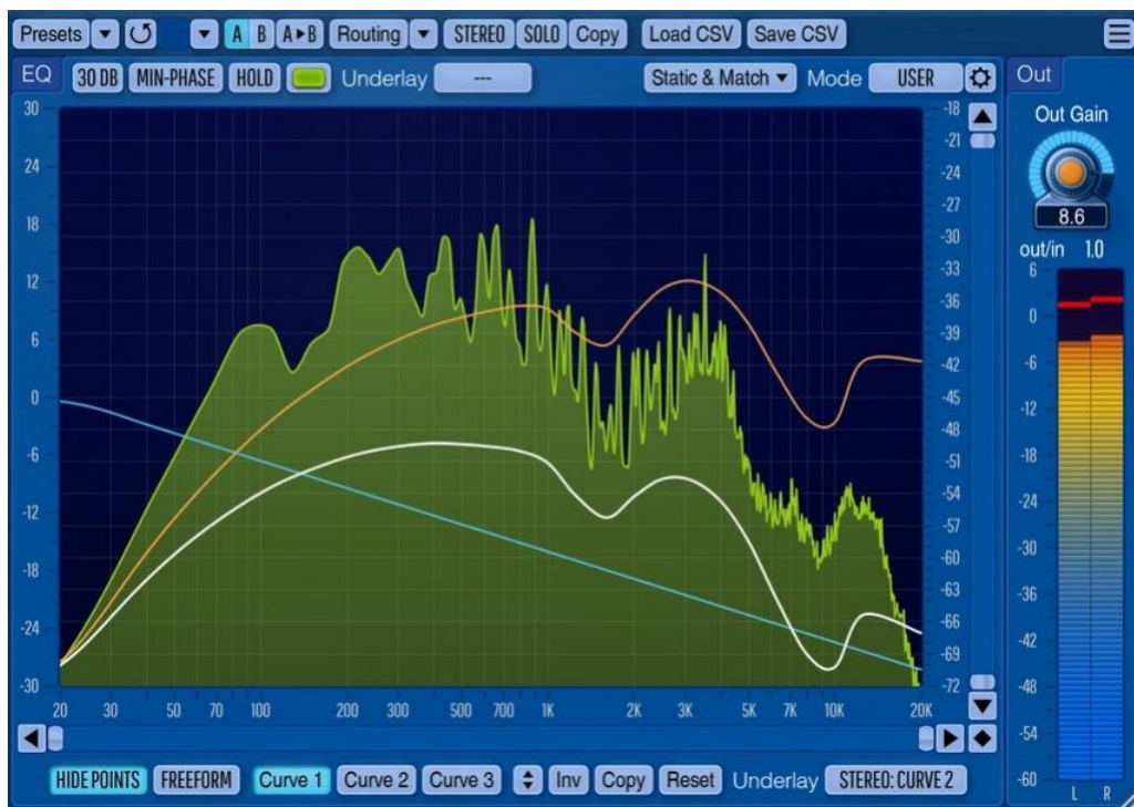
Figure 102 L'égaliseur CurveEQ de Voxengo dispose d'une fonction de mise en correspondance de spectres audio pour obtenir un profil audio similaire
