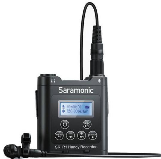
Figure 75 Le SR-R1 Saramonic avec micro cravate ; attaché à la ceinture, sa taille permet de le dissimuler sous les vêtements
