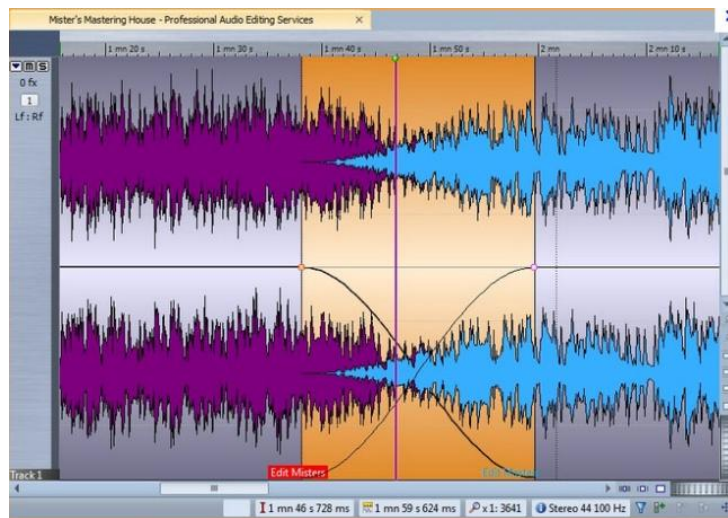
Figure 92 Un crossfade (transition entre 2 éléments). La fin du 1 er est mélangée avec le début du suivant.
