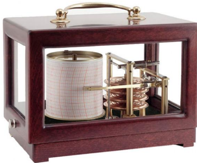
Figure 1 Un baromètre enregistreur. La variation de la pression atmosphérique dessine une courbe. L'équivalent en audio est beaucoup plus rapide. On l'appelle la forme d'onde.
