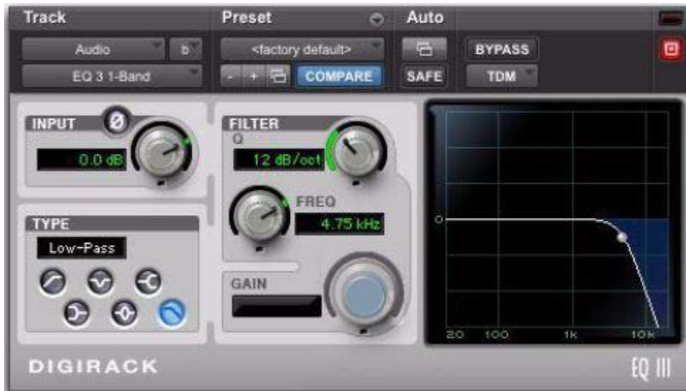
Figure 93 Un filtre passe-bas. Ici, le type de filtre est positionné sur « Low-Pass », la pente est de 12 dB/octave et la fréquence réglée sur 4,75 kHz
