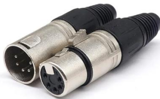
Figure 135 Les connecteurs 5 broches utilisés pour la connexion des micros stéréo
